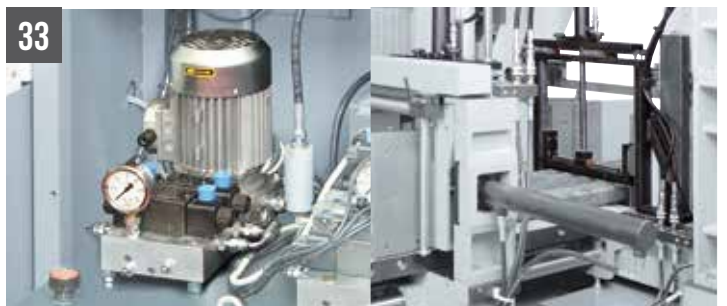
33 SHARK 350 CNC HS 4.0 - SHARK 460 KONNECT Morse verticali idrauliche con centralina idraulica dedicata 350x350 mm
