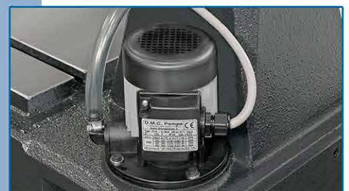
Impianto di refrigerazione • Système d'arrosage • Cooling system • Kuehlanlage
