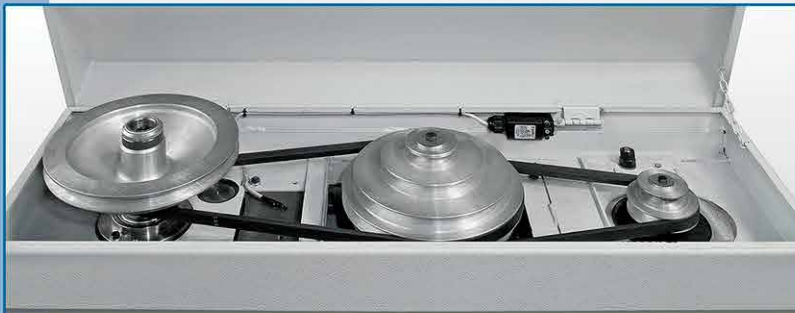
Trasmissione standard Modd. 30/35/40/45 • Trasmissione con pulegge a gradini • Variation des vitesses par poulies étagées • V-belts + pulleys transmission • Riemenscheiben
