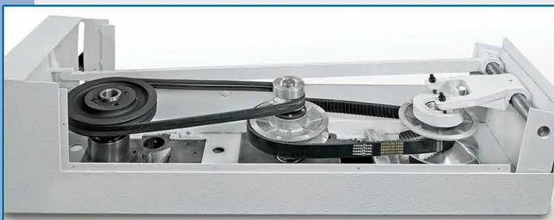
Trasmissione con variatore semplice (VAR.S) Modd. 35/40/45 • Trasmissione con variatore semplice • Variation des vitesses par variateur à courroies • Belts speed variator • Stufenlos
