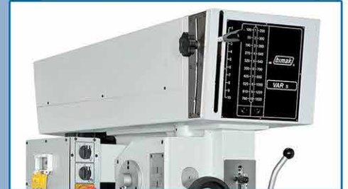
VAR.S (Variatore semplice) • VAR.S (Variateur par courroie) • VAR.S (Toothed belt speed variator) • VAR.S (Stufenlos)
